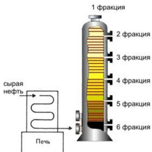
Рисунок 1. Схема устройства для фракционной дистилляции
